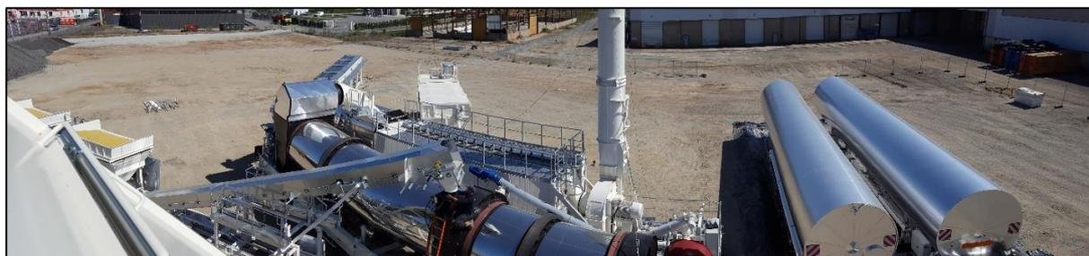
**Figure 7 : Photographies illustratives d'une centrale d'enrobage**
